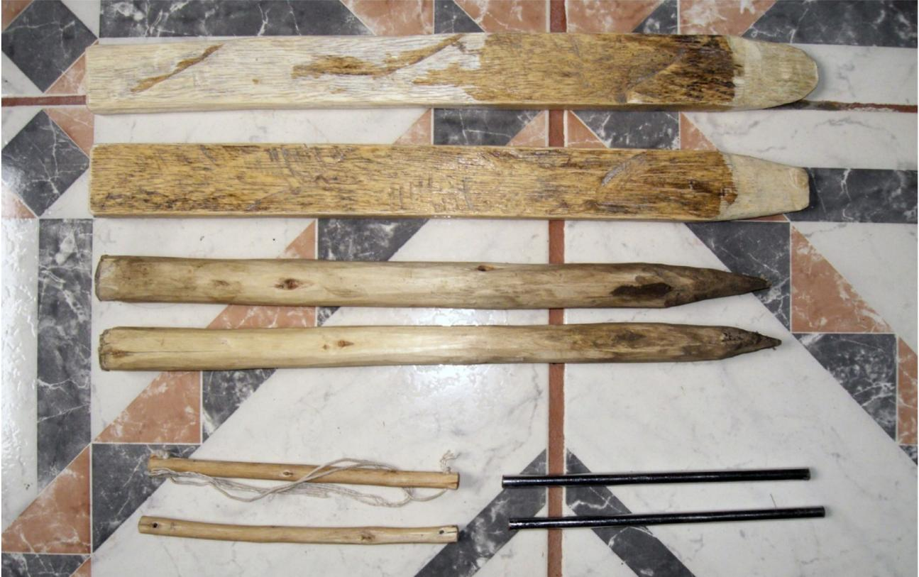
On a besoin de 2 piquets gros et longs, pour l'extrémité de l'ourdissage. Et de 3 piquets plus fins (voir plus selon la technique utilisée).
