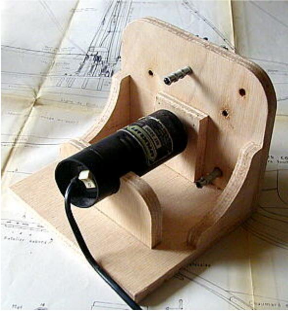
**Vue arrière avec le moteur, ici une mini perceuse Maxicraft qui entraîne la roue dentée centrale. Il y a un léger problème, c'est que la perceuse, même en vitesse lente, tourne beaucoup trop vite. Pour corriger cela il suffit d'interposer entre le transfo Maxicraft et la prise de courant un transfo 110/220v, et là, plus de problème, ça fonctionne au poil. Il va de soit que n'importe quel moteur adapté pour la circonstance conviendra très bien.**
