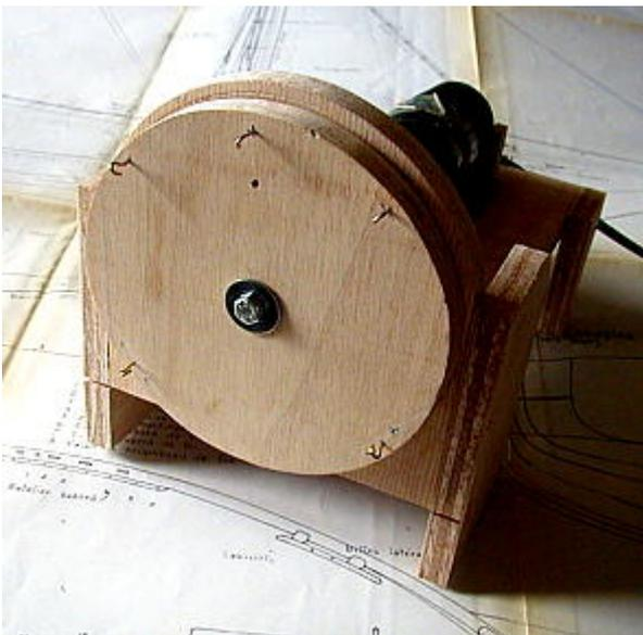
**Le chariot mobile ne fait pas appel aux Lego sauf pour les roues, il est très simple à réaliser. Il comporte 5 crochets, suffisants pour offrir les deux options 3 et 4 brins.**
