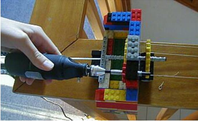
**Une fois cette opération terminée on fait tourner le plateau en sens inverse ( si les torons ont été tournés dans le sens horaire le plateau doit tourner dans le sens anti horaire et vice versa, cela dépend du sens de commettage final que l'on souhaite )**
