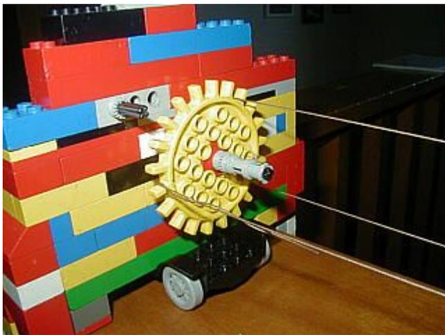
par contre à l'autre extrémité, les trois torons, au lieu de se réunir sur un axe central, doivent être disposés en triangle sur un plateau qui tourne, le chariot central est supprimé.
